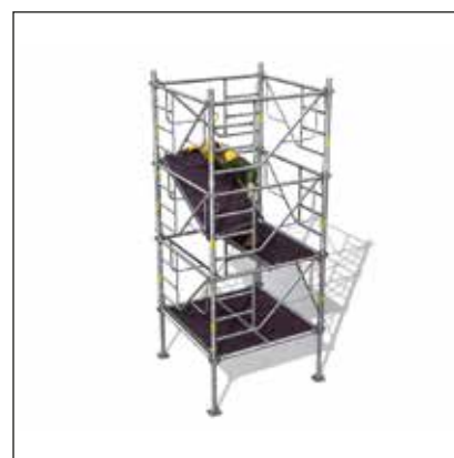
- Remonter les planchers à trappe en position définitive pour obtenir 2,00 m entre niveaux de planchers. - Déplacement du 1 er plancher à trappe.
