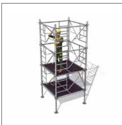
- Montage du 3 e niveau.
