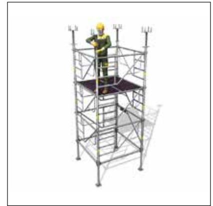
- Mise en place et réglage des vérins de tête.
