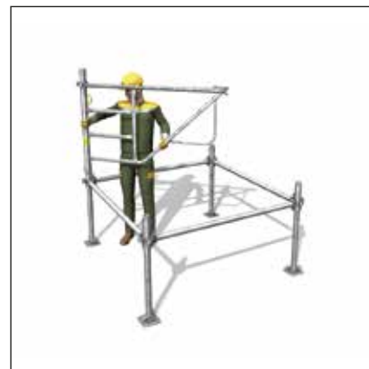
- Depuis l'intérieur de la tour, pose du 1 er cadre dans l'axe de la diagonale puis rotation pour le verrouiller.
