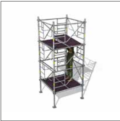
- Déplacement du 2 e plancher à trappe depuis le niveau inférieur.
