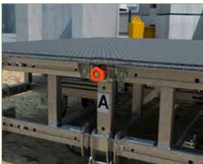
- Vis de réglage (écrou HM36).
