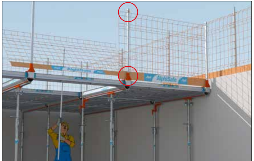
- La grille est verrouillée en tête par l'ergot anti-soulèvement et bloquée en pied.
