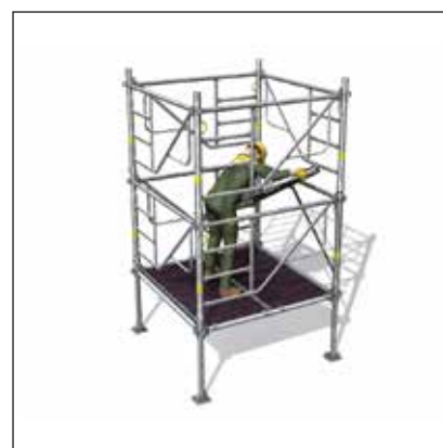
- Monter un niveau de plancher en position provisoire. - Pose d'un 1 er plancher à trappe de 1 m.
