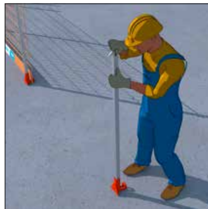
- Clipser le potelet dans l'adaptateur.
