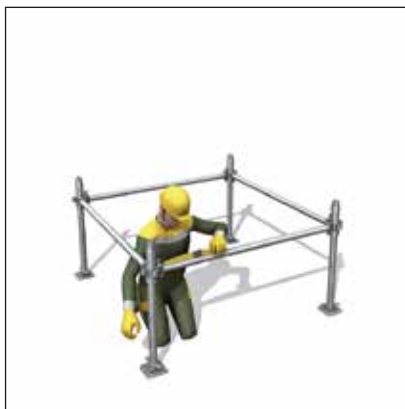
- Implantation et mise à niveau.
